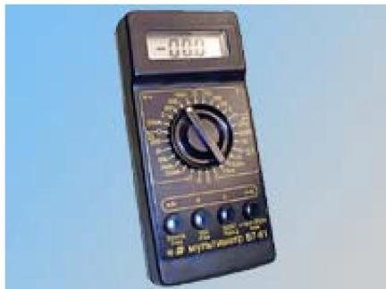
Мультиметр В7-61 **производства ООО "РИП-Импульс"** (г.Краснодар) предназначен для измерения электрических величин: напряжения и силы постоянного и переменного токов, а также сопротивления постоянному току и тестиирования р-п переходов.
